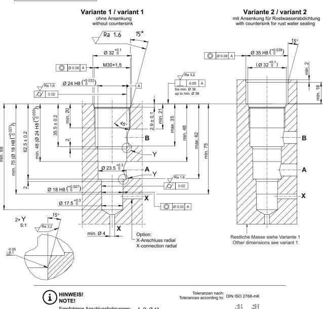
Empfohlene Anschlussbohrungen: A, B: Ø 10 Recommended connection bores: X: Ø 4
